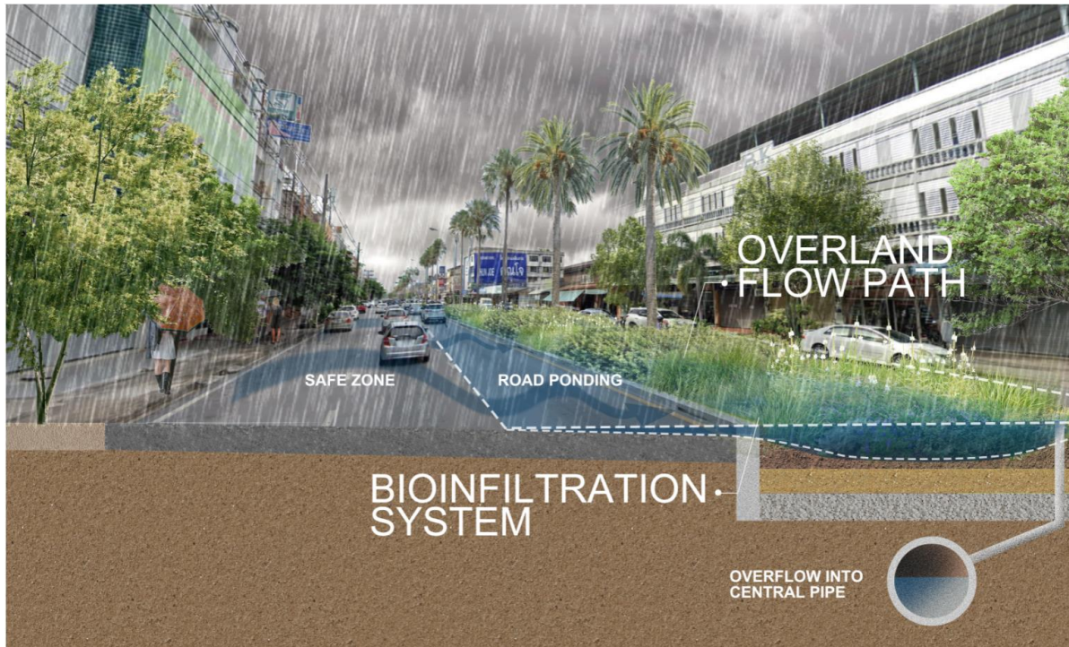
ภาพที่ 10 : ภาพประกอบของเกาะกลางที่ก่เป็นร่องและระบบกรองชีวภาพบนถนนสายหลักในจังหวัดระยอง ที่มา: Tiange Wu, Water Sensitive Cities Australia
