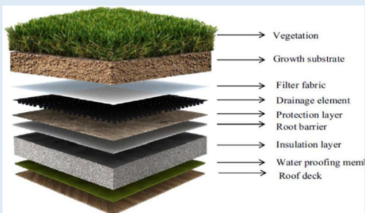
ภาพที่ 16: องค์ประกอบของหลังคาสีเขียว (ซ้าย) และบาร์บนชั้นดาดฟ้าของโรงแรมโนโวเทล กรุงเทพมหานคร (ขวา)
