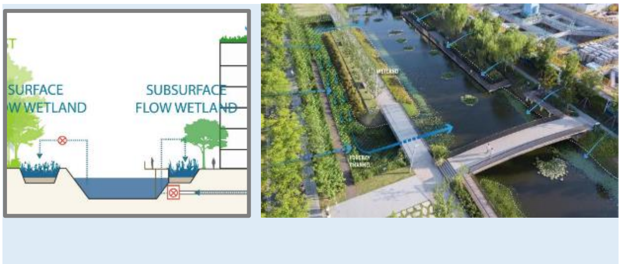
ภาพที่ 11: การออกแบบระบบสวนชุ่มน้ำแบบบนผิวน้ำ (ซ้าย) และตัวอย่างจากเขตชุมชน ชัยภูมิ (ขวา) ที่มา: คณะทำงาน (ซ้าย), Sasaki (ขวา)
